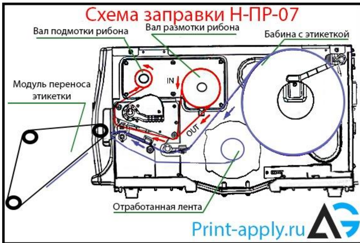
Рисунок 3. Схема заправки этикетки и риббона типа «Out» в принтер Godex ZX1300xi
